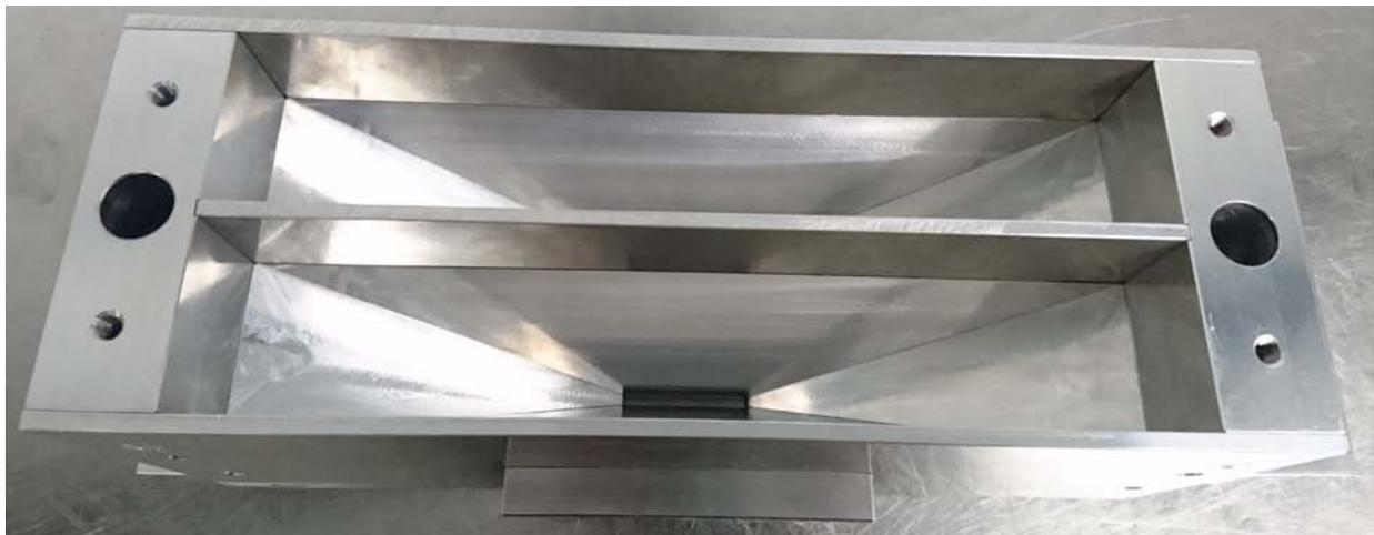
*Figure 31: Multi-Material-Recoater*
