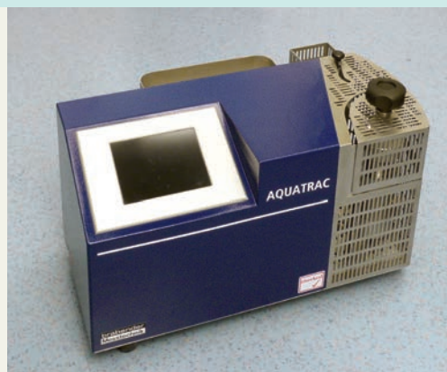
Moisture measurement device, AQUATRAC, Brabender Messtechnik GmbH
