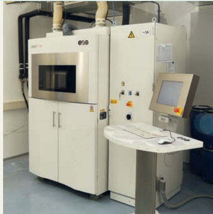
Polymer Laser Sintering Machine, EOSINT P395, EOS GmbH
