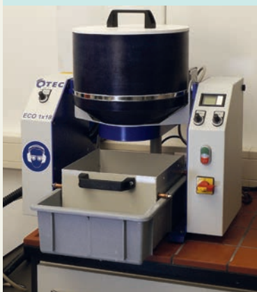
Centrifugal force device, ECO 18, OTEC Präzisionsfinish GmbH
