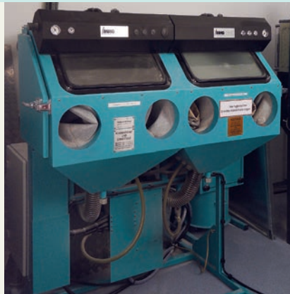
Glass sphere & Corundum blasting cabin, SMG 25DUO, MHG Strahl- anlagen GmbH
