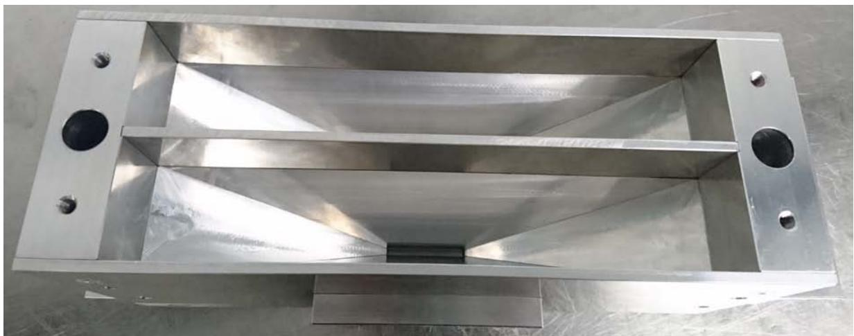
Figure 31: Multi-Material-Recoater
